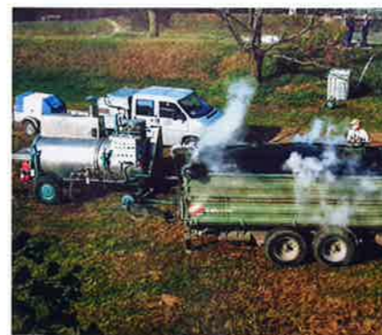
Remorque avec dispositif de stérilisation: la stérilisation sur remorque peut se faire directement sur place. Une remorque de l'exploitation est équipée.
