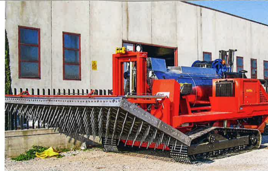
Traitement par injection de vapeur: la vapeur pénètre dans le sol à une température de 80 à 90°C par le biais de cylindres injecteurs.
