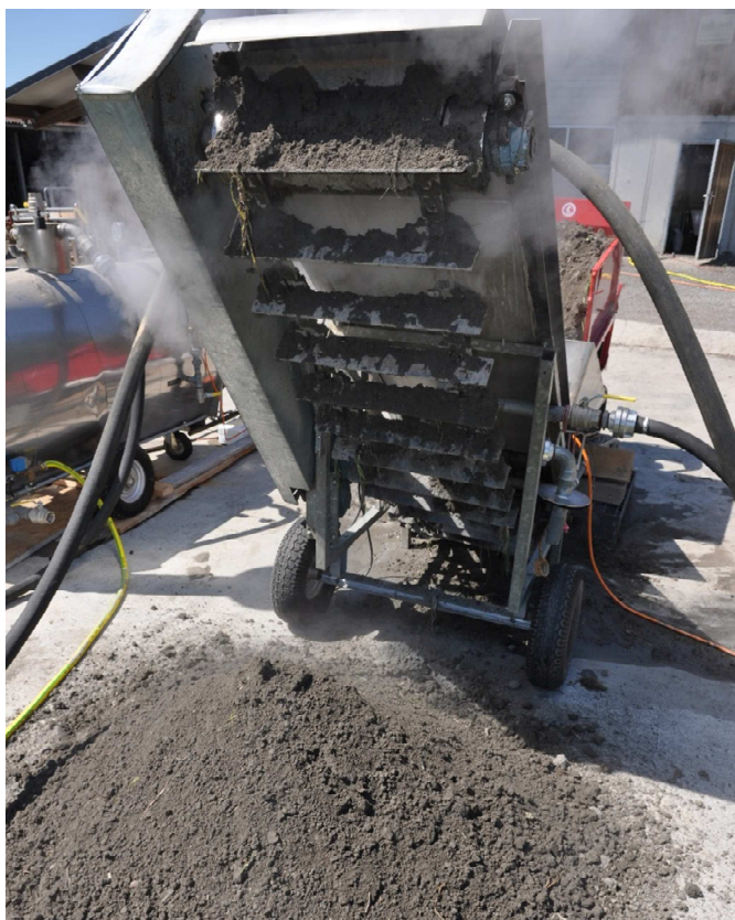
Figure 6 : Le convoyeur à bande permet de stériliser directement sur place la terre décapée. Il convient à de petites surfaces (photo : R. Total, Agroscope).
